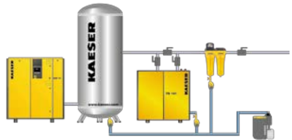
Druckluft-Aufbereitung (Filter, Kondensat-Aufbereitung, Adsorptionstrockner, Aktivkohleadsorber)
