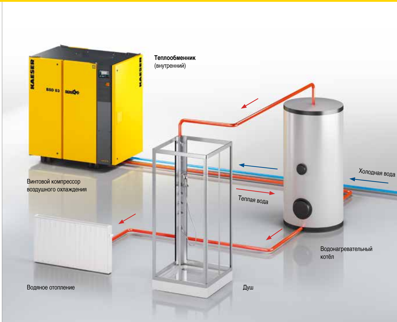
Рис.: Схема рекуперации тепла, использование для питьевой воды только со специальным безопасным теплообменником
